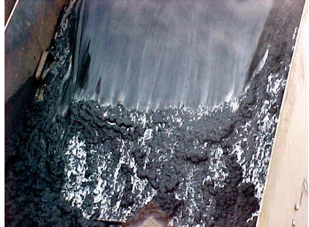
Figura 2: Simulación en vitro de las varias etapas de decantación del agua de ceniza en el interior del decantador, después de la etapa de floculación.
