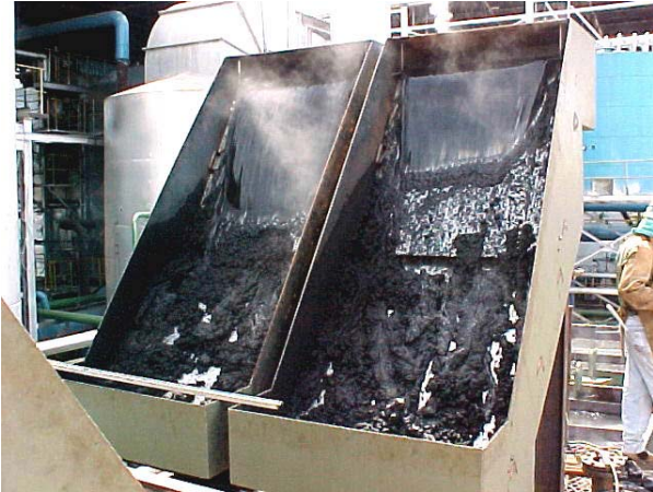
Figura 2: Simulación en vitro de las varias etapas de decantación del agua de ceniza en el interior del decantador, después de la etapa de floculación.
