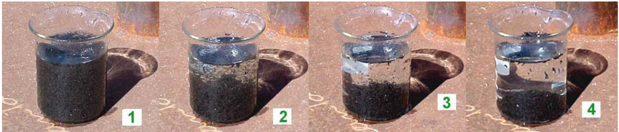
Figura 2: Simulación en vitro de las varias etapas de decantación del agua de ceniza en el interior del decantador, después de la etapa de floculación.
